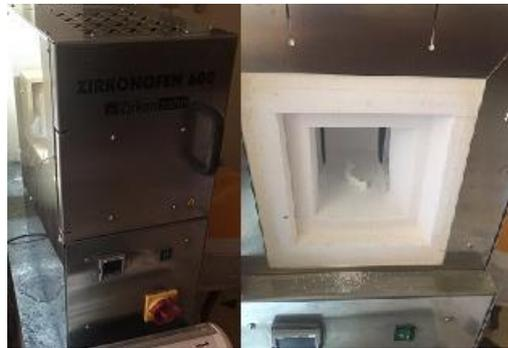
الشكل (17): جهاز التقسية الخاص بنظام Zircodenta
